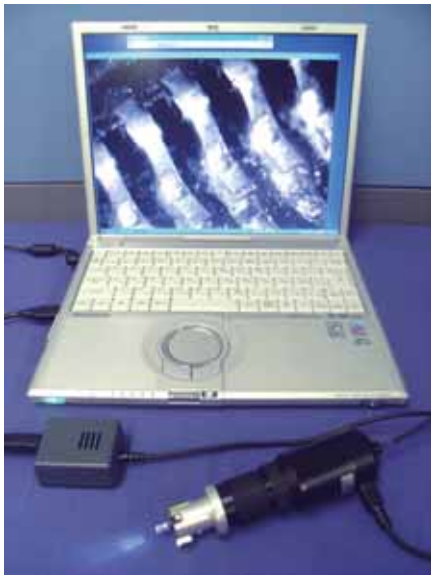
PC接続キット(USBパック) でパソコンに接続できます。
